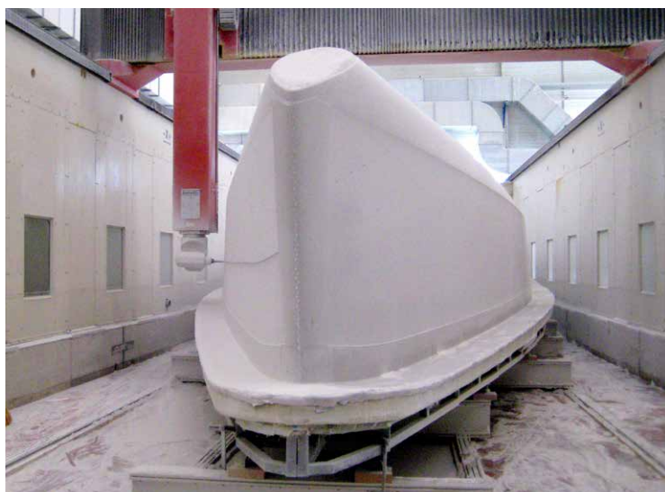
Nel centro di lavoro Belotti prende vita lo stampo dello scafo di 20,37 m di lunghezza con una tolleranza di appena 1 mm.
